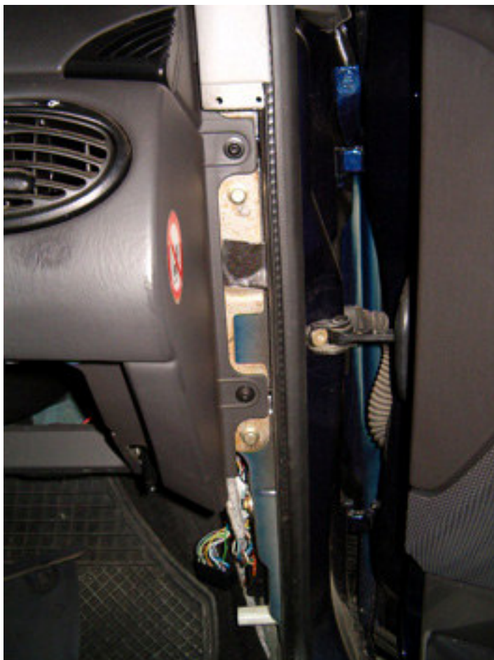
Desmontaje de embellecedor de puerta
